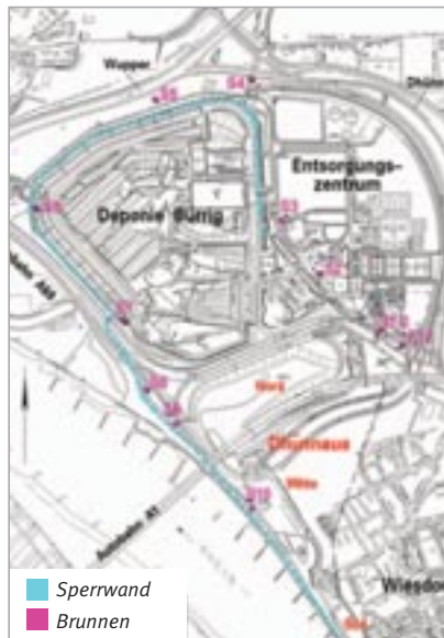
Die 3,6 km lange Grundwasserbarriere dichtet die Altlast und die Deponie Bürrig gegen Rhein, Wupper und Dhünn ab.
